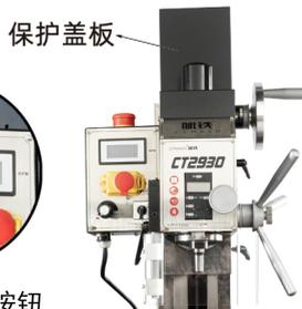
打开机床的主轴箱的保护盖板前必须将电源插头拔出。
